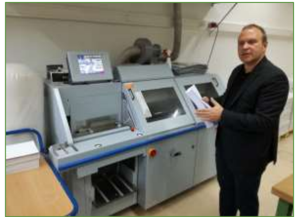
Abbildung 3 – Geschäftsführer Herr Ploschnitzig erklärt die Heißklebemaschine zum Binden von Softcoverdrucken.
